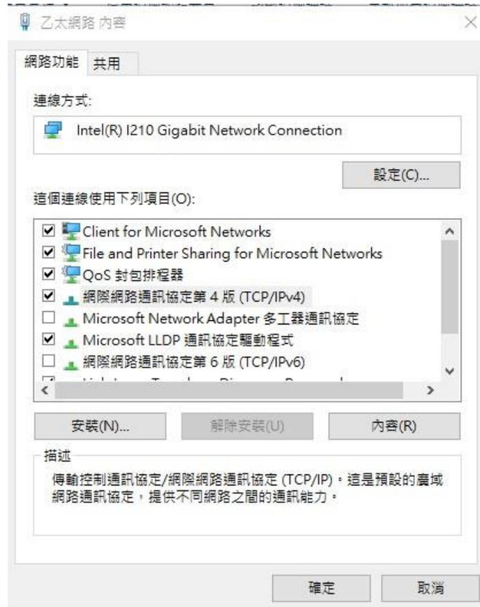
6. 在【網際網路通訊協定第 4 版(TCP/IPv4)】視窗，在【一般】選項中，選擇【自動取得 IP 位址(O)】，以及【自動取得 DNS 伺服器位址(B)】，然後選擇【確定】及選擇【關閉】，此時電腦會開始與系統連線，待視窗自動關閉，如下圖所示。
