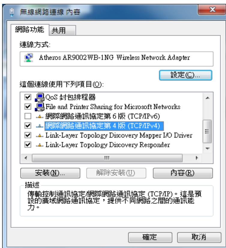
13. 在【網際網路通訊協定第 4 版(TCP/IPv4)】視窗，在【一般】選項中，選擇【自動取得 IP 位址(0)】，以及【自動取得 DNS 伺服器位址(B)】，然後選擇【確定】及選擇【關閉】，此時電腦會開始與系統連線，待視窗自動關閉，如下圖所示。
