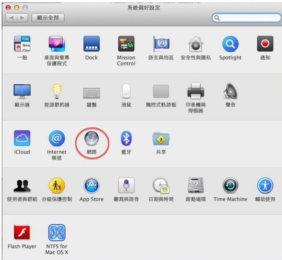
2. 點選並網路後，左半部介面視窗請選擇【乙太網路/Ethernet/USB Ethernet】並在點選【進階】如下圖所示：
