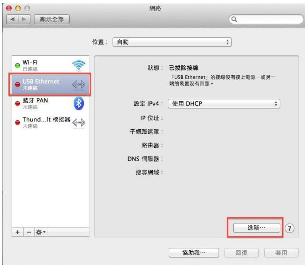
3. 點選【TCP/IP】選項在設定 IPv4 中選擇【使用 DHCP】如下圖所示：
